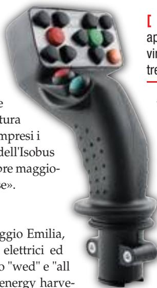
[ Il joystick firmato **Salvarani**, ottimizzato per le applicazioni di irrorazione, è compatibile con qualsiasi virtual terminal Isobus compliant, in grado di operare su tre pagine di shift, rendendo disponibili 39 tipi di funzioni.
